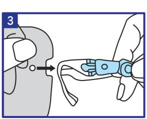
シールドの穴をバックルボルト方向へいれます
